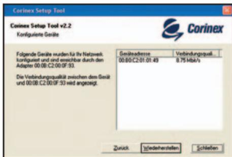
Das Gerät mit der MAC-Adresse 00:0B:C2:00:0F:93 arbeitet als ein Netzwerk-Agent und identifiziert die einzelnen Adapter, die in der Liste unter **Geräteadresse** angeführt sind, als Geräte, die zum Netzwerk gehören. Die Funktion der Geräte und Performance zwischen dem Agenten 00:0B:C2:00:0F:93 und den anderen im Netzwerk identifizierten Adaptern wird unter **Verbindungsqualität** angezeigt.
